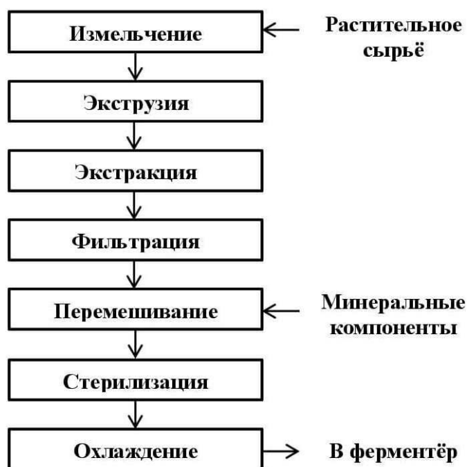
Рис. 1. Операционная технологическая схема приготовления питательной среды на основе экструдированного растительного сырья
